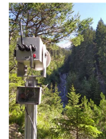
Abbildung 7: HF-Radar mit »Blick« auf den Dawinbach.
